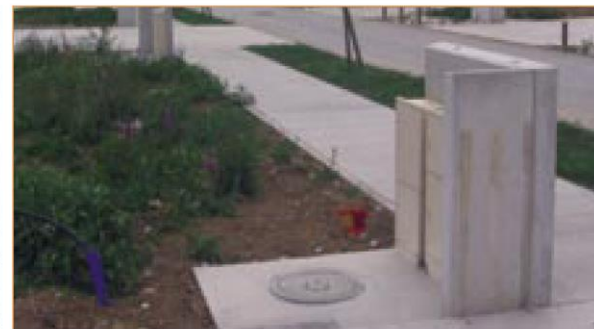
L'intégration des coffrets dans un petit muret construit à l'identique sur l'ensemble de l'opération permet d'en réduire l'impacts.
